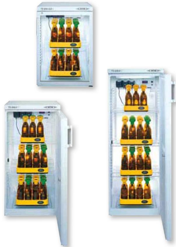
die Arbeit mit dem System OxiTop® Control geeignet, da der Datenabruf durch die geschlossene Glastür erfolgen kann. Dies hat den Vorteil, Temperaturschwankungen durch Öffnen der Tür zu vermeiden.
